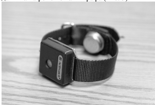
Рисунок 3. Актиграф и датчик температуры для мониторинга ритма сна-бодрствования.
